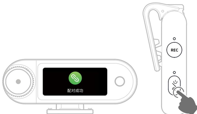
1. Mic 关机状态下，长按开机键 6 秒进入配对模式。
