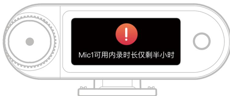
当 Mic 内录存储时长不足 30 分钟时，相机 RX 上提示“Mic x 可用内录时长仅剩半小时”。存储空间满后继续录音会覆盖最初的录音文件滚动录制，可通过相机 RX 格式化内存或连接电脑删除。
