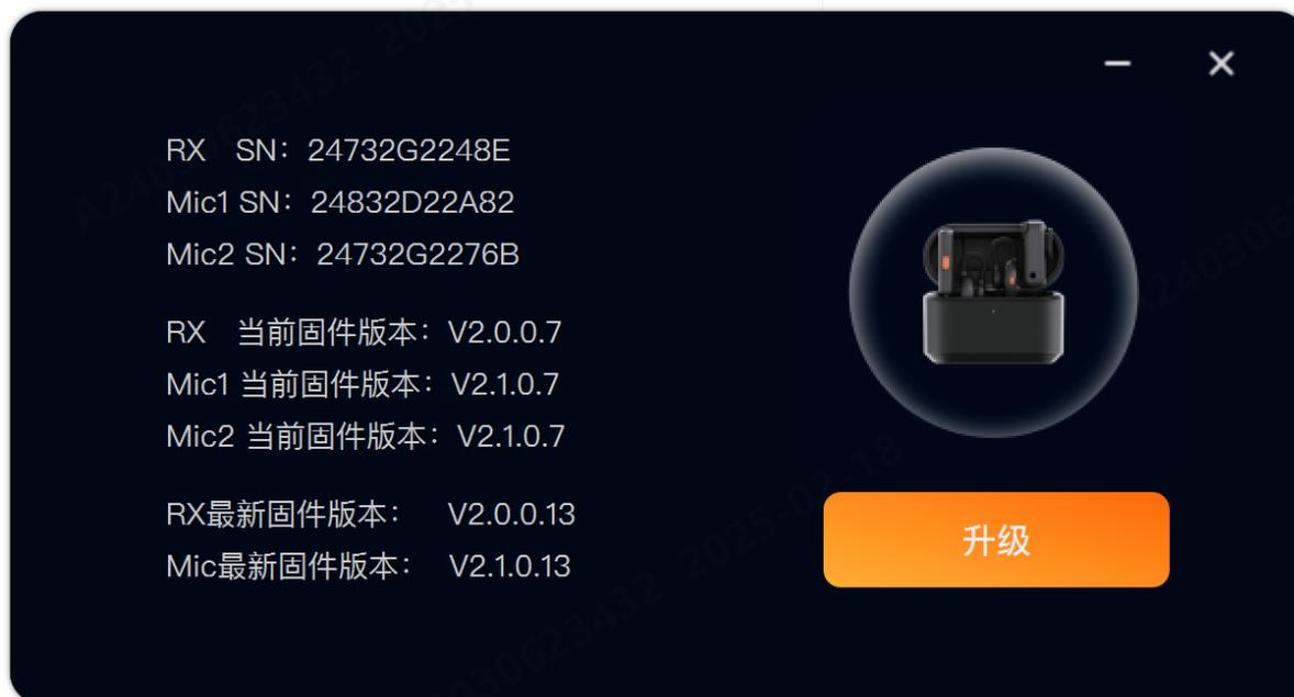
4、点击升级 TX、RX 即可进入升级状态，升级过程大约需要 几分钟，升级时 TX、RX 指示灯会显示玫红色常亮状态，待上位机升级进度条走完，显示升级成功界面时，表示麦克风已经完成升级操作；
