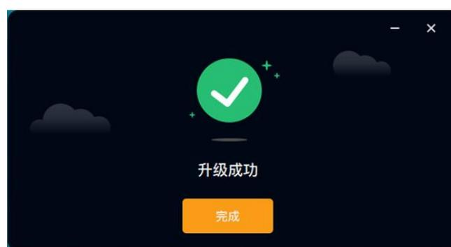
5、升级完成之后，点击完成，上位机会重新识别设备，待重新识别到设备之后，观察 TX 以及 RX 版本跟上位机显示最新固件版本是否一致，一致则表示以及升级成功，此时关闭上位机之后，即可拔掉设备；
