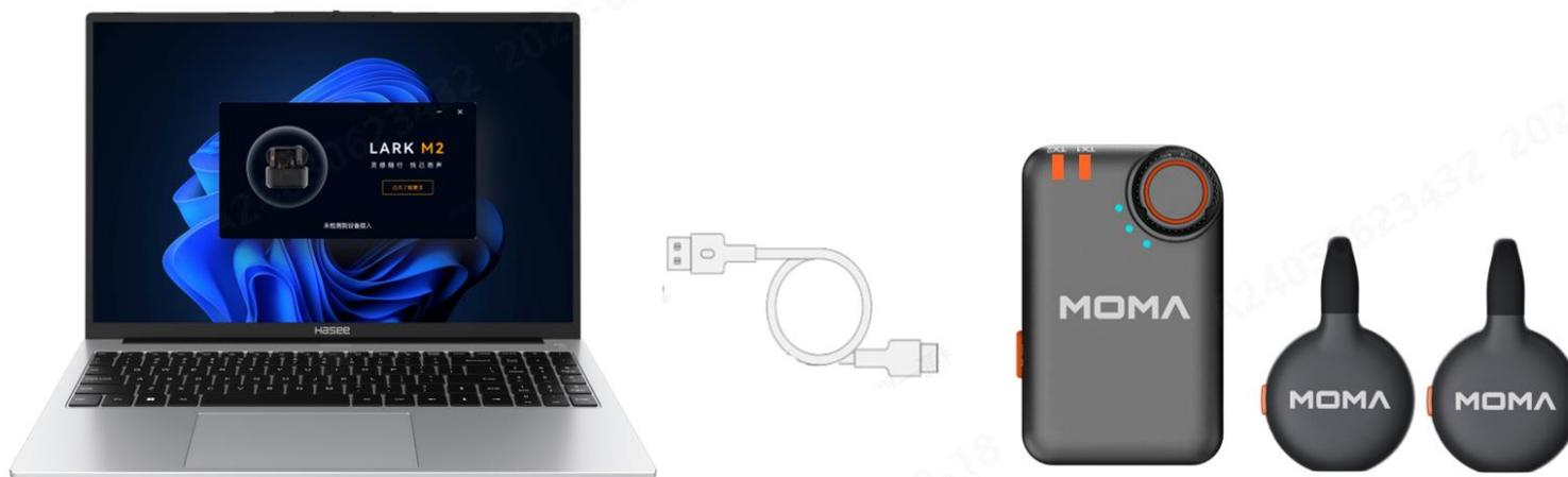
3、TX、RX 连接电脑之后，上位机会自动识别设备，获取最新固件版本信息；（如若获取信息失败，点击重试即可重新获取）
