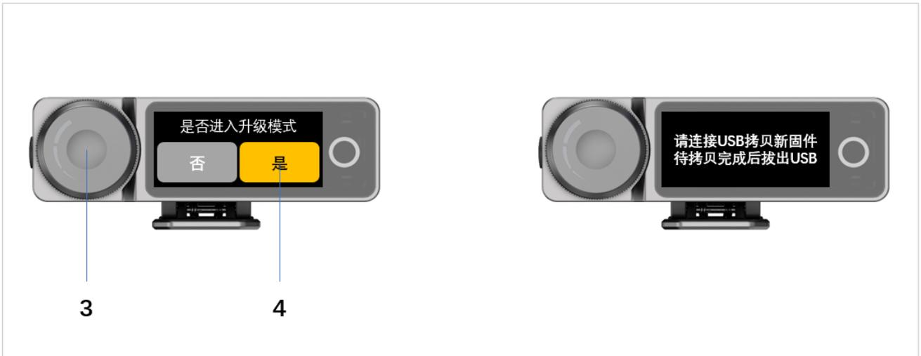
3. 接收器通过 USB 线连接上电脑，然后将对应的升级文件拷贝到接收器生成的 U 盘驱动中；
