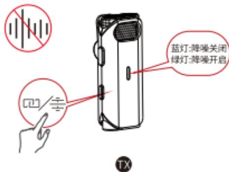
短按TX发射器黄色按键，开启降噪功能，发射器指示灯变绿。
