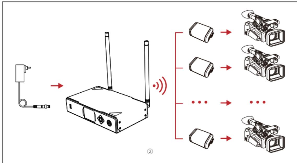
2. 请按图示方式将 Tally 灯安装至拍摄设备上
